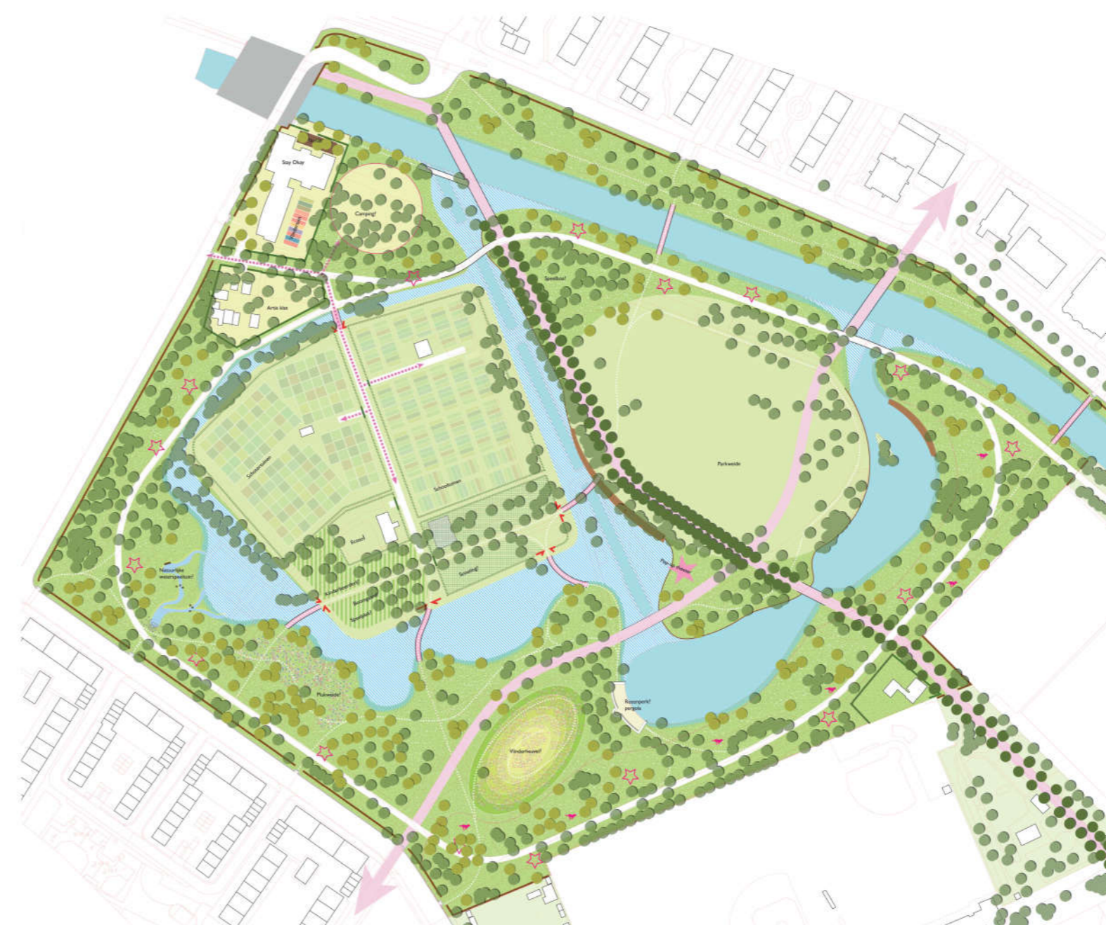
Fase 1: Vergroten van het wateroppervlak en verwerking van de vrijgekomen grond in het park (microreliëf en heuvel).
